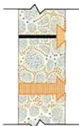
Ispuna otvora sa PENECRETE MORTAR™ . Nastavak rasta kristala.
