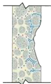
Segregirani beton. Štemovanje. Čišćenje. Kvašenje.
