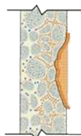
Ispuna segregacije sa PENECRETE MORTAR™ . Nastavak rasta kristala.
