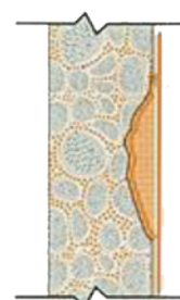
PENETRON® premaz preko popunjene segregacije i okolne površine. Nastavlja se rast kristala.
