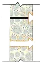
“Lastin rep” dimenzije 3x3x4 cm. Uklanjanje (dela) stranog tela. Čišćenje. Kvašenje. PENETRON® premaz. Počinje formiranje kristala.
