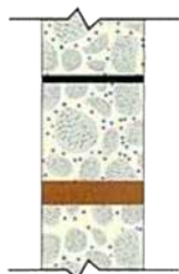
Metalne šipke i drvene paknice u betonskom zidu.
