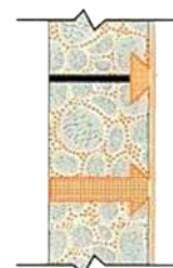
PENETRON® premaz preko popunjenog otvora i okolne površine. Nastavlja se rast kristala.
